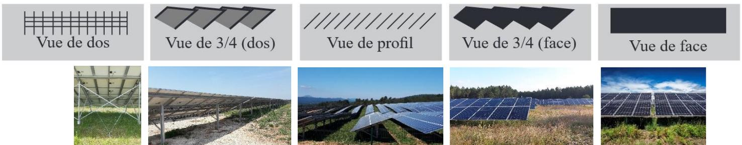
L'installation des châssis sur pieux avec un enfoncement déterminé en fonction de la topographie a l'avantage de préserver la structure du site. Ainsi les rangées de châssis suivront parfaitement les lignes du relief.
