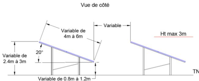
Les châssis ou tables présenteront une inclinaison de 20 à 25° par rapport à l'horizontale afin d'optimiser la production photovoltaïque annuelle par rapport à la latitude du site. Les structures sont fixes et orientées vers le Sud formant des lignes d'axe Est-ouest.
